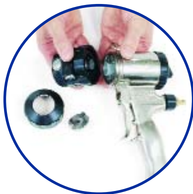
Vyjměte z pistole kapalinovou sekci
