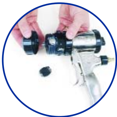
Snadný přístup sejmutím předního krytu
